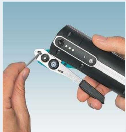
Mit dem CF CRIMPHANDY CUTTER schneiden Sie Leiter komfortabel und korrekt auf Länge. Die Montage des praktischen Cutters erfolgt schnell und unkompliziert.
